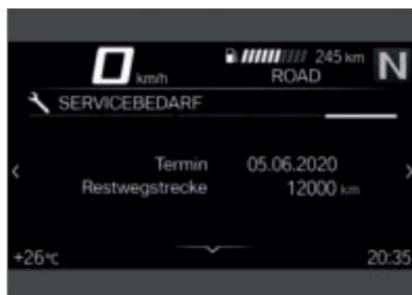
Liegt die verbleibende Zeit bis zum nächsten Service innerhalb eines Monats oder wird der nächste Service innerhalb von 1000 km fällig, so wird eine weiße Check-Control-Meldung angezeigt.
