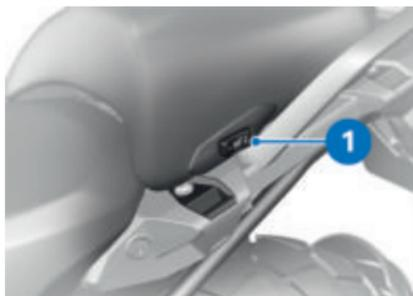
• Mit Schalter **1** die gewünschte Heizstufe auswählen.
