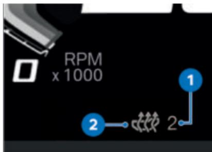
Die gewählte Heizstufe **1** und das Sitzheizungs-Symbol **2** werden im Display angezeigt.
